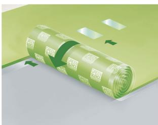
Rollen Sie die nächste Green Silence Matte neben der bereits ausgelegten Dämmbahn aus. Die Stöße sollten, zur Vermeidung von Schallbrücken und Verschiebungen, während der Fußbodeninstallation mit einem Klebeband überklebt werden.
