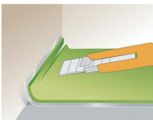
Sie können Green Silence mit einem Teppichmesser o. dergleichen an einer Seite auf die gewünschte Breite zuschneiden. Vermeiden sie bei der Verlegung Fugenstöße der Dämmunterlage die mit Stößen des Bodenbelags zusammentreffen.
