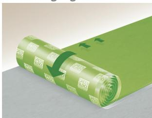
Planen Sie die Verlegerichtung ihres Fußbodens und installieren Sie die Green Silence Bahnen im 90° Winkel zur langen Seite des zu verlegenden Fußbodens. Die Papierseite zeigt dabei nach oben und die Dampfbremse gegen den Rohfußboden. Legen Sie Green Silence am äußeren Rand des Installationsraums an und rollen Sie es so aus, dass ein direkter Kontakt mit dem Unterboden entsteht.
